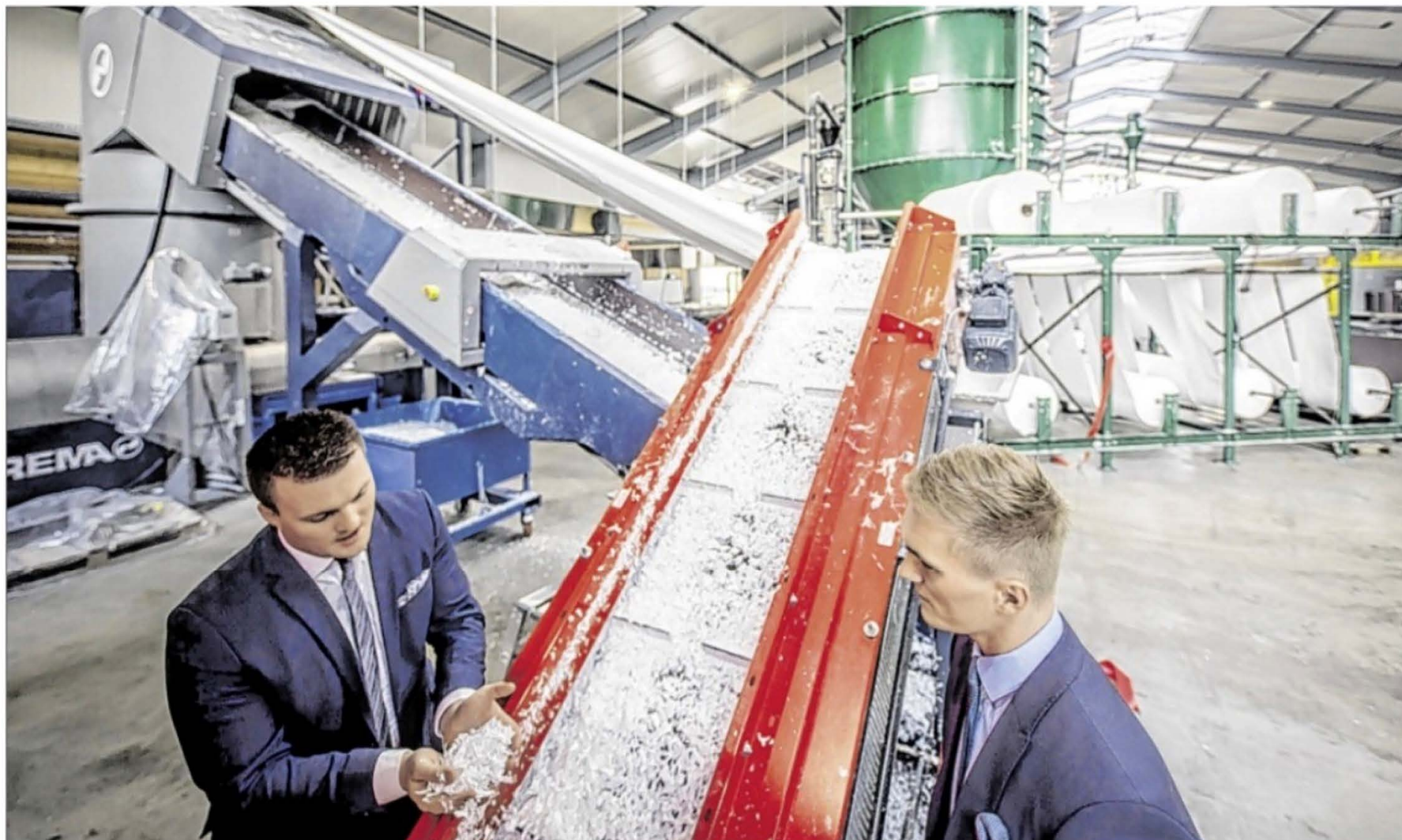
Arne Bohlen (links) prüft frisch geschredderten Kunststoff, der über Förderbänder in den Extruder transportiert wird. Stefan Bohlen sieht ihm dabei zu. Eine nahezu baugleiche Anlage soll jetzt noch in Halle 13 auf dem Firmengelände entstehen.
